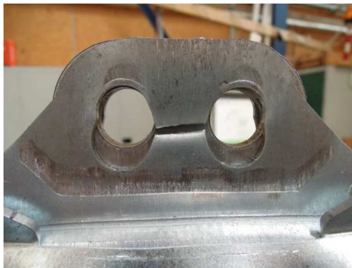
Abbildung 49: Bruch durch block-tearing an den \varnothing 16 Durchsteckschrauben
